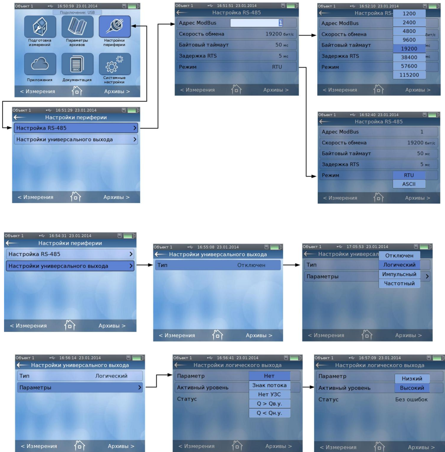
Рис.Г.8. Меню «Настройки периферии» / «Настройка RS-485» и «Настройки универсального выхода» / Тип Логический»
